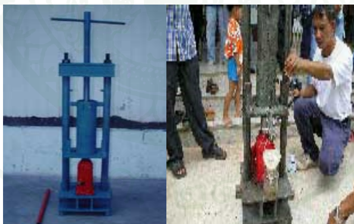
ภาพที่ 9 เครื่องสกัดน้ำมันสบูดำโดยใช้แรงงานจากคน
