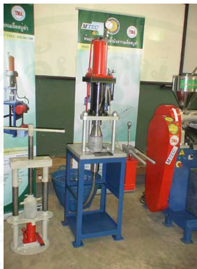
ภาพที่ 10 เครื่องหีบน้ำมันสนุ่นดำด้วยระบบไฮดรอลิก
