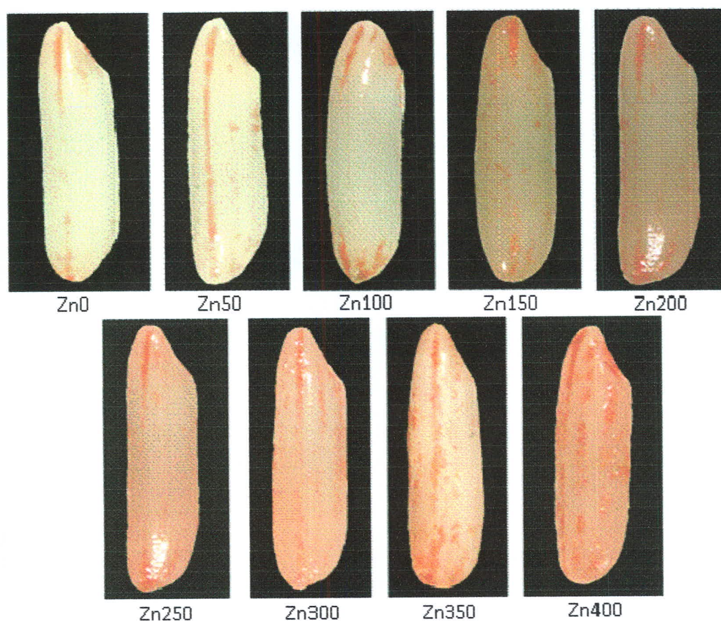
ภาพที่ 6 ความเข้มข้นของปริมาณธาตุสังกะสีที่เติมลงไปในช่วงกระบวนการนึ่งข้าวที่ตรวจสอบได้ด้วยการย้อมสีด้วย DTZ
