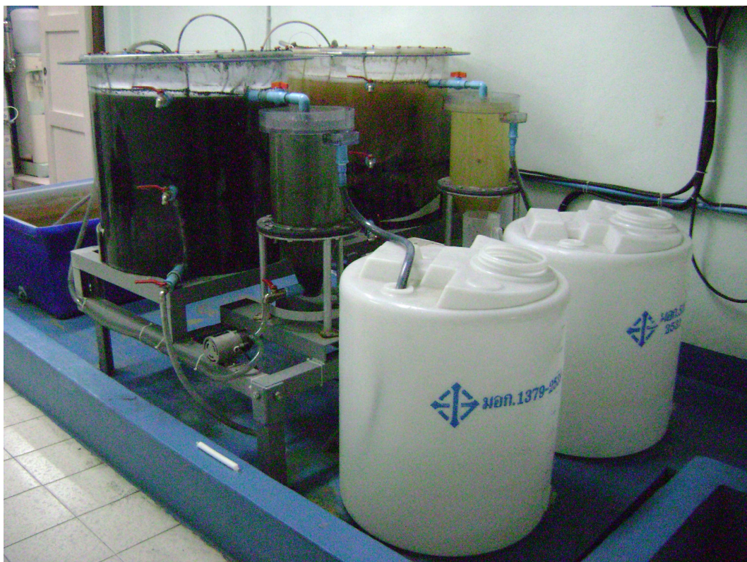
รูปที่ 3.3 โมเดลระบบบำบัดน้ำเสียที่ใช้ในการวิจัย (ต่อ)
