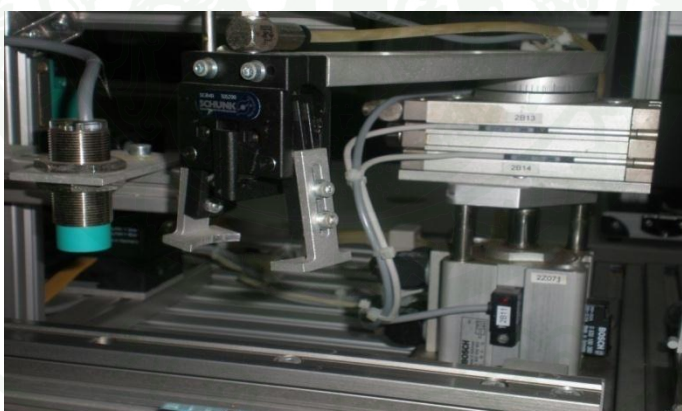
ภาพที่ 12 แขนกลเคลื่อนย้ายชิ้นงานตัวที่ 1 ในระบบการผลิต MSS
