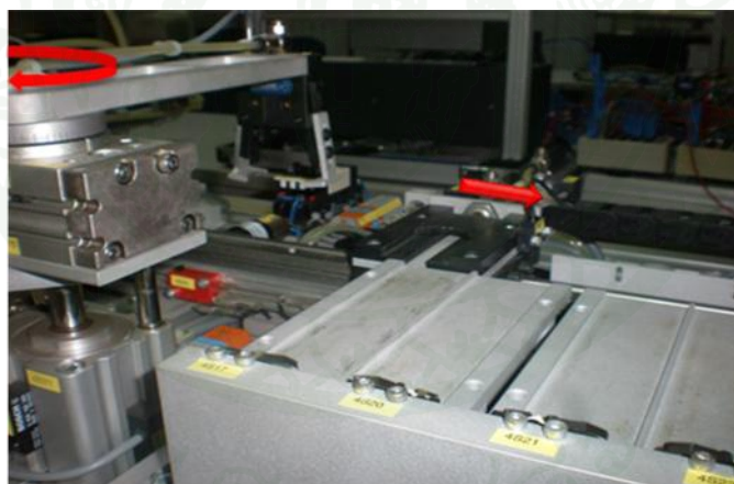
ภาพที่ 36 แขนกลตัวที่ 2 กลับสู่สภาวะพร้อมทำงาน และสถานีที่ 3 จัดเก็บชิ้นงานในระบบการผลิต MSS
