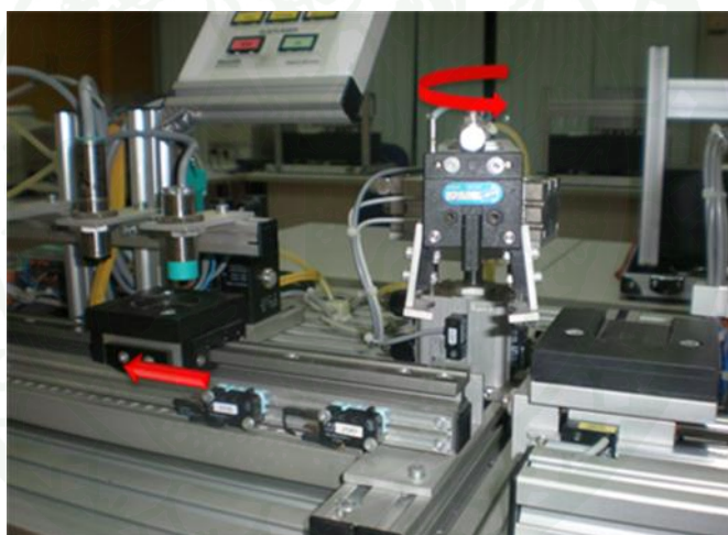
ภาพที่ 24 แขนกลตัวที่ 1 เคลื่อนย้ายชิ้นงานและสถานีที่ 1 กลับสู่สภาวะพร้อมทำงานในระบบการผลิต MSS
