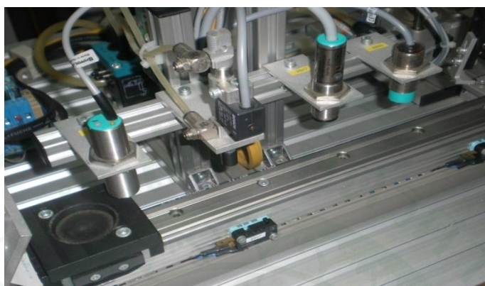
ภาพที่ 11 สถานีที่ 1 สถานีตรวจสอบชิ้นงานในระบบการผลิต MSS
