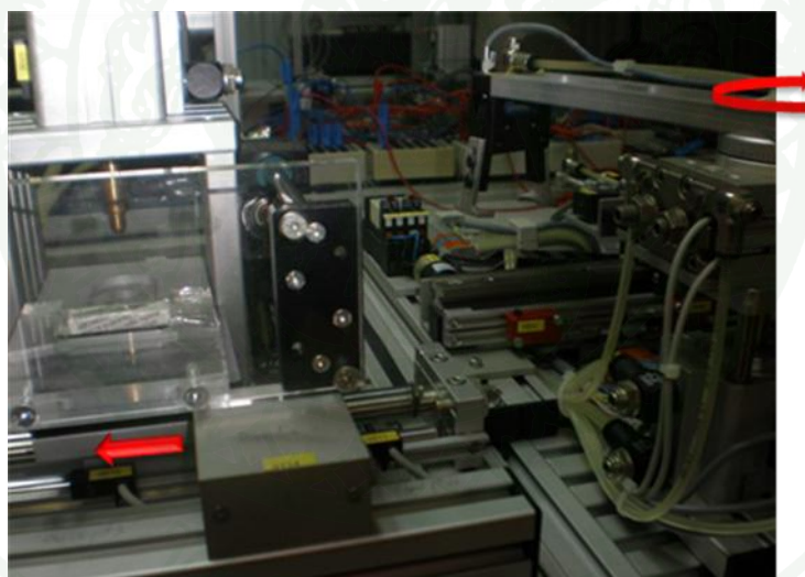
ภาพที่ 31 แขนกลตัวที่ 2 เคลื่อนย้ายชิ้นงานและสถานีที่ 2 กลับสู่สภาวะพร้อมทำงานในระบบการผลิต MSS
