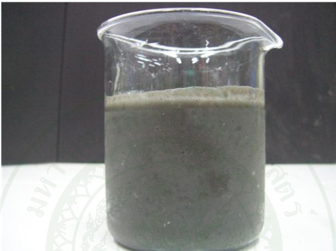
ภาพผนวกที่ 1 สลัดจ์จากถังตกตะกอนของระบบบำบัดน้ำเสียแบบเอเอส ก่อนรีดน้ำ
