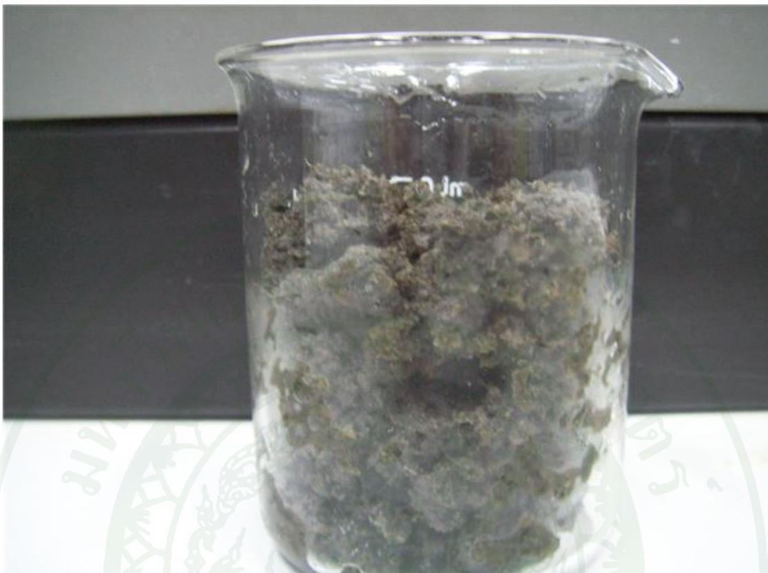
ภาพผนวกที่ ๖2 สลัดจ์จากถังตกตะกอนของระบบบำบัดน้ำเสียแบบเอเอส ที่ผ่านการรีดน้ำ
