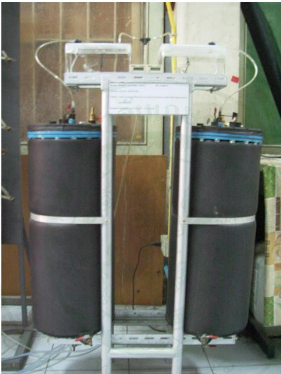
ภาพผนวกที่ 3 ชุดอุปกรณ์ที่ใช้ในกระบวนการหมักแบบไร้อากาศ
