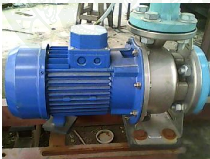
ภาพที่ 6 ปั้มน้ำหือ EBARA ประกอบกับ TEFC Motor 3 hp @ 2850 rpm
