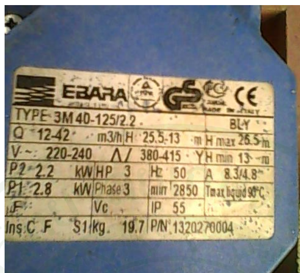
ภาพที่ 5 เนมเพลทของปั้มน้ำ EBARA รุ่น 3M 40-125/2.2
