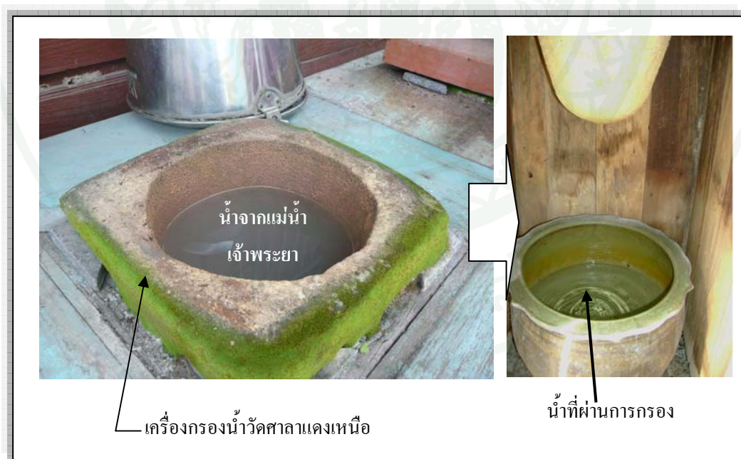
ภาพที่ 28 เครื่องกรองน้ำโบราณ ทำจากหินทราย และเซรามิค อายุกว่า 100 ปี ณ วัดศาลาแดงเหนือ ใช้สำหรับกรองน้ำจากแม่น้ำเจ้าพระยา เพื่อการบริโภคของพระภิกษุ
