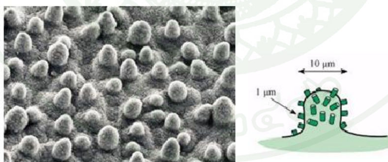
ภาพที่ 5 ภาพถ่ายขยายผิวใบบัวด้วยกล้องจุลทรรศน์อิเล็กตรอนแบบส่องกราด (SEM)
