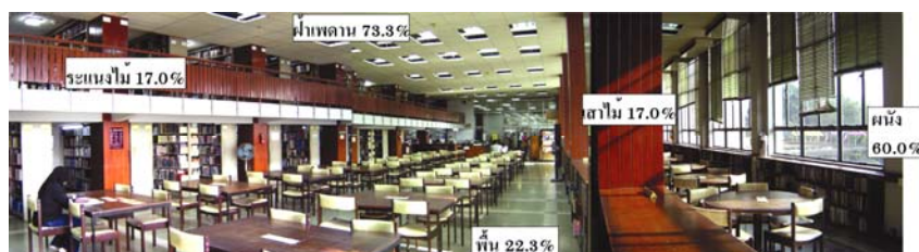
ภาพที่ 70 แสดงค่าการสะท้อนแสง และค่าการส่องผ่านแสงของวัสดุต่างๆ
