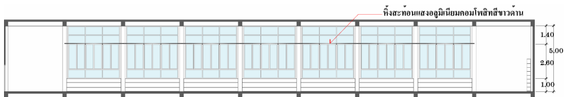
ภาพที่ 85 แสดงรูปตัด B ของหิ้งสะท้อนแสงแบบ D2 วัสดุอะลูมิเนียมคอมโพสิตสีขาวด้าน
