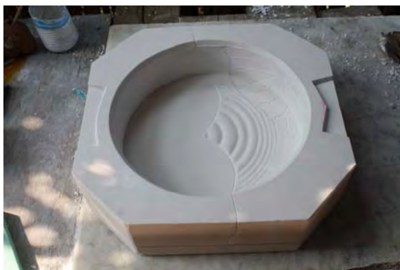
ภาพที่ 81 แสดงลักษณะพื้นผิวจากต้นแบบภายในแม่พิมพ์
