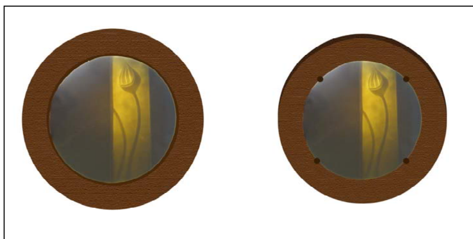
ภาพที่ 63 แสดงการติดตั้งของโคมไฟผนังกับฐานไม้
