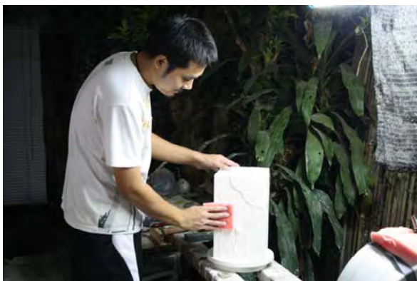
ภาพที่ 90 แสดงการเซ้ดชิ้นงานก่อนการพ่นเคลือบ
