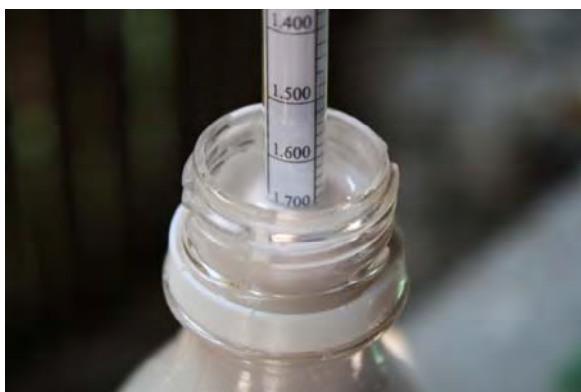
ภาพที่ 85 แสดงการวัดความถ่วงจำเพาะของเนื้อดิน
