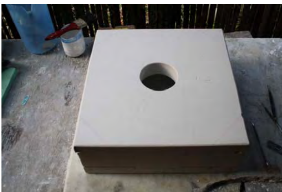
ภาพที่ 79 แสดงแม่พิมพ์ส่วนบนและรูหล่อน้ำดิน
