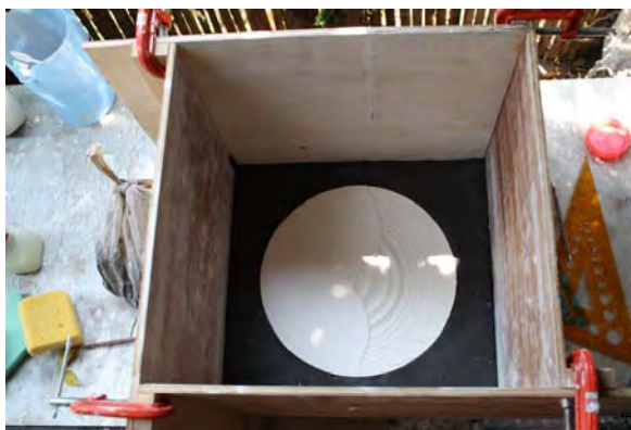
ภาพที่ 71 ก้นแบบพิมพ์สำหรับเทปูนด้วยดินและไม้ก้นแบบ
