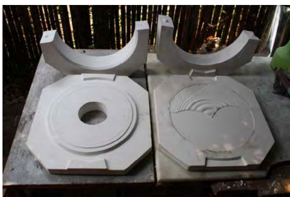
ภาพที่ 82 แม่พิมพ์หล่อกลวงแบบ 4 ชั้นเสร็จสมบูรณ์
