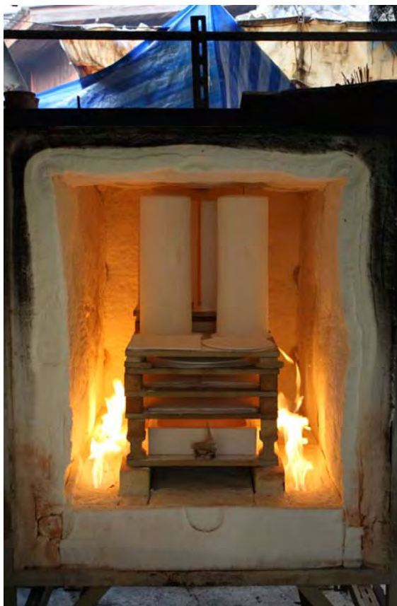
ภาพที่ 92 แสดงการเผาเคลือบที่อุณหภูมิ 1,250 °C
