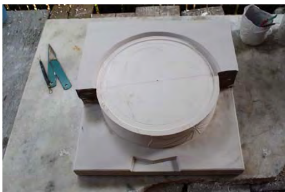
ภาพที่ 76 แสดงลักษณะพิมพ์ด้านข้างและเดือยล็อก
