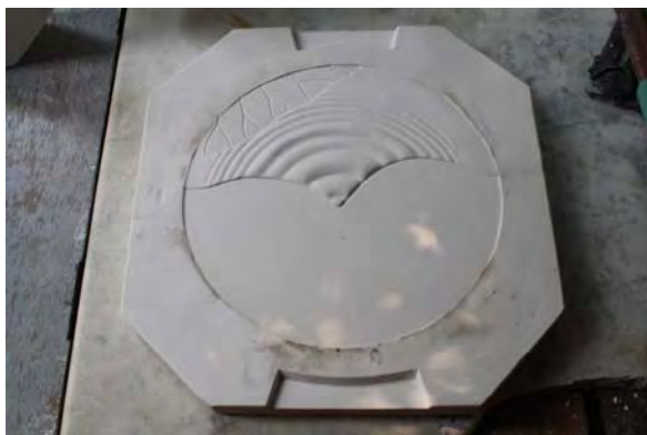
ภาพที่ 75 แม่พิมพ์ส่วนฐานและแสดงเดือยล็อกพิมพ์
