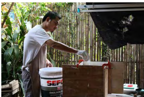
ภาพที่ 74 เทปูนอย่างช้าๆ เพื่อไม่ให้เกิดฟองในแม่พิมพ์
