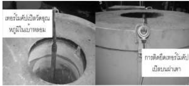
รูปที่ ข-10 แสดงลักษณะเทอร์โมคัปเปิ้ลที่ใช้วัดอุณหภูมิ
