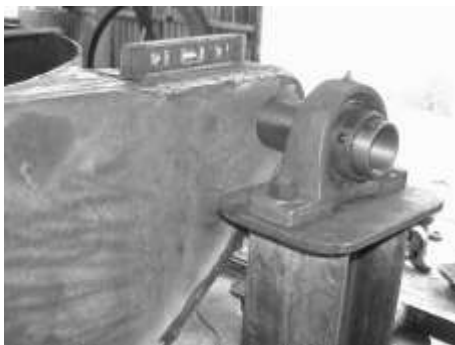
รูปที่ 3.9 การปรับระดับ ความเที่ยงตรงเตาหลอม
