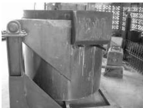
รูปที่ 3.13 การวางระบบทางออกเปลวไฟ จากการเผาไหม้ในเตา
