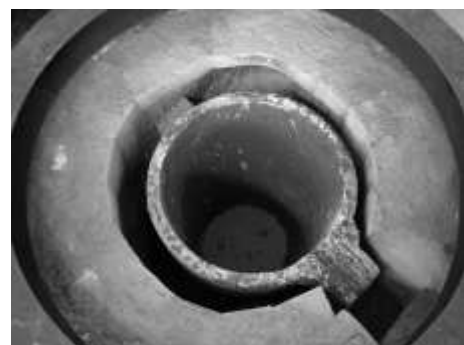
รูปที่ 3.14 การติดตั้งบ้ำหลอมในเตา
