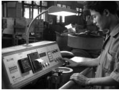
รูปที่ 2.17 เครื่องมือตรวจสอบปริมาณ การละลายของไฮโดรเจน ALU 90 [10]
