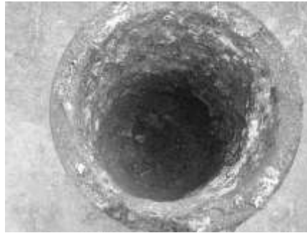
รูปที่ 2.6 ภายในบ่่าที่เกิดความเสียหายจะพบว่า มีการเกิดการสะสมของอะลูมิเนียมออกไซด์ อยู่ภายในจำนวนมาก [2]
