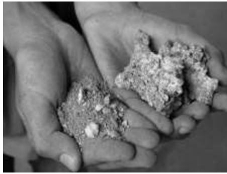
รูปที่ 2.22 ลักษณะของซีโลสที่เกิดขึ้น ดรอสที่มีอะลูมิเนียมติดออกมาน้อย (รูปซ้ายมือ) และมาก (รูปขวามือ) เนื่องจากใช้ฟลักซ์ต่างชนิดกัน[12]
