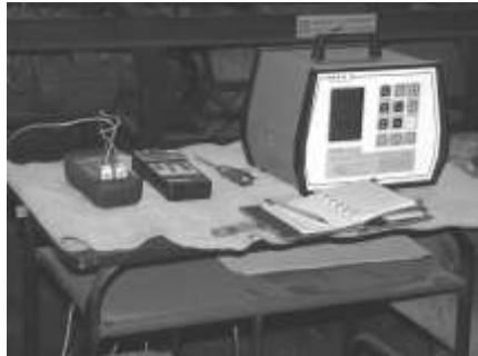
รูปที่ 2.36 เครื่องวัดประสิทธิภาพการเผาไหม้เชื้อเพลิง [25]
