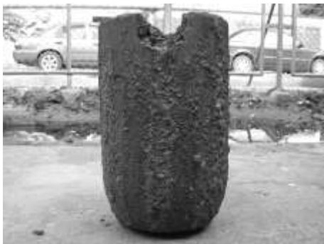
รูปที่ 2.3 ความเสียหายที่ปากเบ้าหลอมซึ่ง สาเหตุหลักมาจากการเกิดออกซิเดชัน [2]
