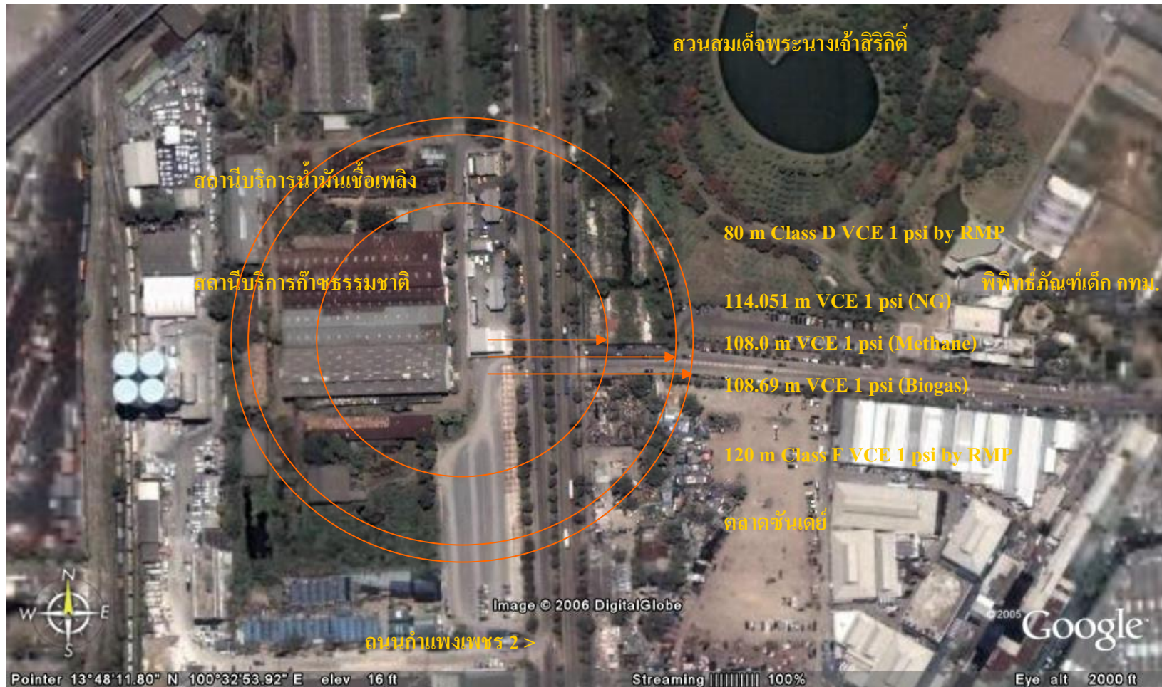
ภาพผนวกที่ ค 4 ภาพแผนผังความเสี่ยงการเกิด Vapour Cloud Explosion 1 psi ที่ความสูง 2000 ฟุต
