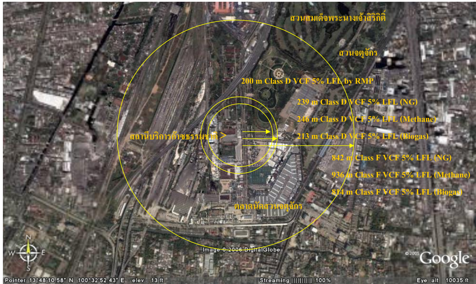
ภาพผนวกที่ ค 5 ภาพแสดงความเสี่ยงการเกิด Vapour Cloud Fire ที่ความสูง 10,035 ฟุต
