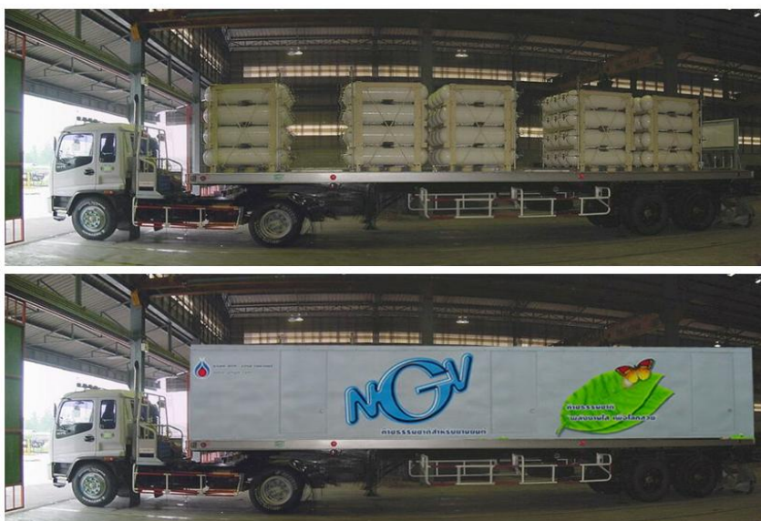
ภาพผนวกที่ ก 4 รถขนส่งก๊าซแบบติดตั้งถังเก็บและจ่ายก๊าซแบบ ANSI/AGA NGV 2 ที่มา: ปตท. (2544)
