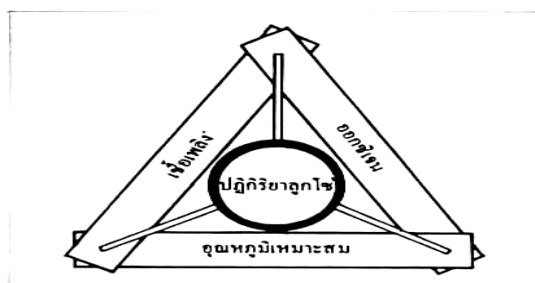
ภาพที่ 1 แสดงสามเหลี่ยมของเพลิงไหม้ ซึ่งประกอบจากชิ้นส่วนสำคัญคือ เชื้อเพลิง ออกซิเจน อุณหภูมิที่เหมาะสมและปฏิกิริยาลูกโซ่
