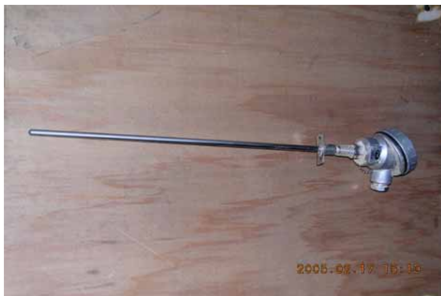
ภาพผนวกที่ ก3 แสดงอุปกรณ์ตรวจจับความร้อน
