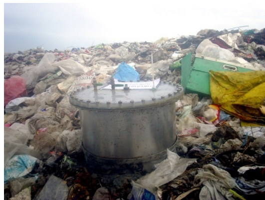
ข. การเก็บตัวอย่างก๊าซโดยการครอบฟลักซ์บนพื้นผิวมูลฝอยแบบเทกองกลางแจ้ง
