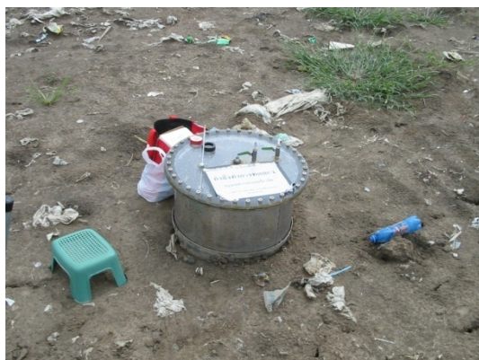
ก. การเก็บตัวอย่างก๊าซโดยการครอบฟลักซ์บนพื้นผิวดินกองมูลฝอยที่มีดินกลบทับ
