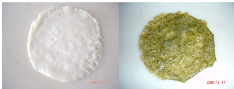
ภาพที่ 4 ไข่ขาวที่ไม่ผสมไข่ น้ำ และไข่ขาวที่ผสมไข่ น้ำขึ้นรูปเป็นแผ่น
