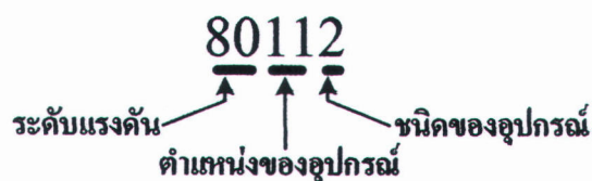
รูปที่ 2.10 ตัวอย่างหมายเลขตัวตัดวงจรของการจัดเรียงแบบแบบบัสคู่เบรกเกอร์คู่
