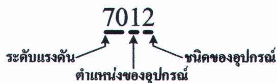
รูปที่ 2.9 ตัวอย่างหมายเลขตัวตัดวงจรของการจัดเรียงแบบบัสหลักและบัสถ่ายโอน
