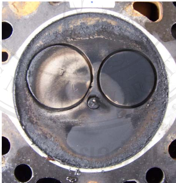
รูป 4.10 สภาพฝาสูบของเครื่องยนต์หลังการทดสอบ 200 ชั่วโมง (ณัฐวุฒิ และคณะ, 2551)
