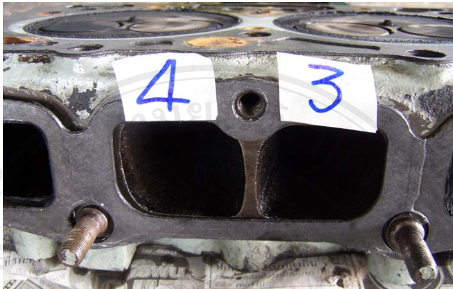
รูป 4.13 ช่องทางออกของท่อไอเสียของเครื่องยนต์หลังการทดสอบ 200 ชั่วโมง (ณัฐวุฒิ และคณะ, 2551)
