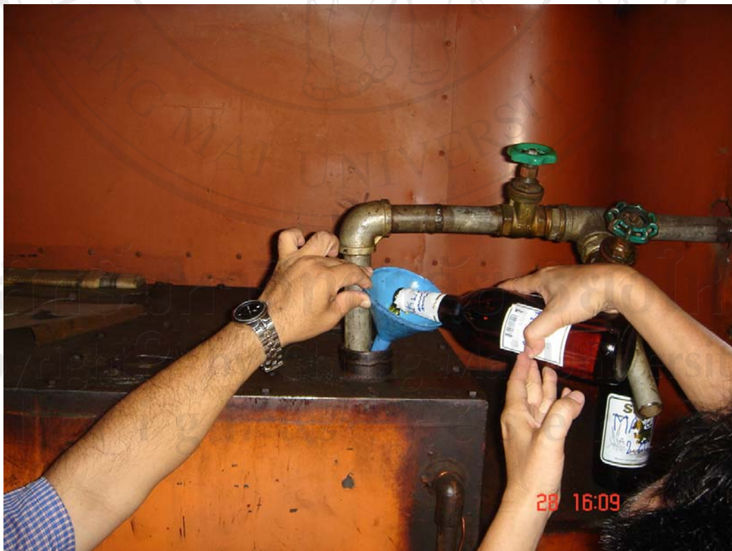
รูป 4.23 การเติมสารเพิ่มประสิทธิภาพในน้ำมันดีเซลอัตราส่วน 800 ppm
