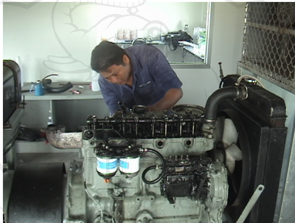
รูป 3.4 การถอดชิ้นส่วนเครื่องยนต์ดีเซลกำเนิดไฟฟ้าขนาด 25 กิโลวัตต์ (ณัฐวุฒิ และคณะ, 2551)
