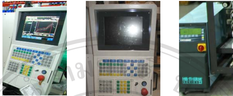
ภาพที่ 3.8 แผงควบคุมเครื่องฉีดพลาสติกแบบอัตโนมัติและเครื่องควบคุมอุณหภูมิน้ำหล่อเย็น
