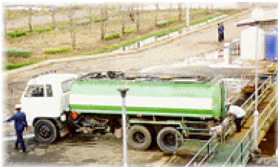
ภาพที่ 2 ลักษณะรถที่ใช้ในการขนส่งน้ำเสียจากโรงงานฟอกย้อมและโรงงานชุบโลหะ
