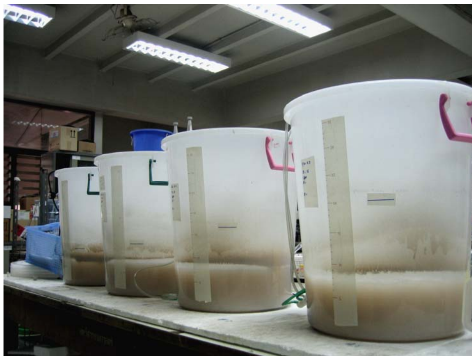
ภาพที่ 10 ถังปฏิกรณ์แบบเอสบีอาร์ (Sequencing Batch Reactor, SBR) ขนาด 40 ลิตร
