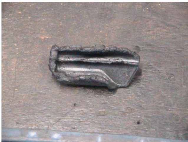
ภาพผนวกที่ ค2 ลักษณะของเสียที่เกิดขึ้นกับชิ้นงานจากการฉีดยางไม่เต็มแม่พิมพ์
