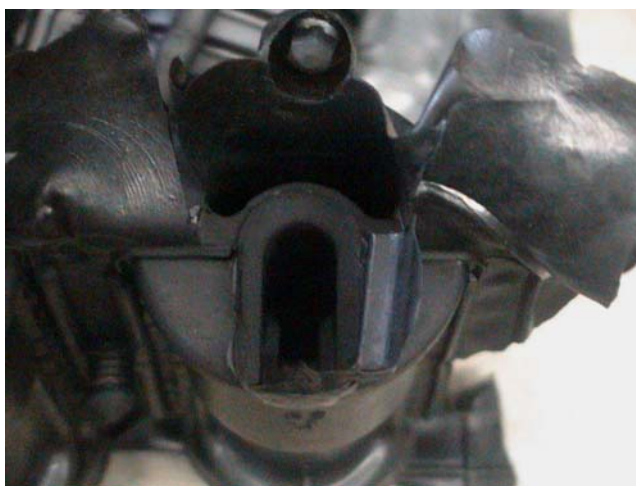
ภาพผนวกที่ ค1 ลักษณะของเสียที่เกิดขึ้นกับชิ้นงาน โดยเกิดการขาดของชิ้นงานที่บริเวณขอบ
