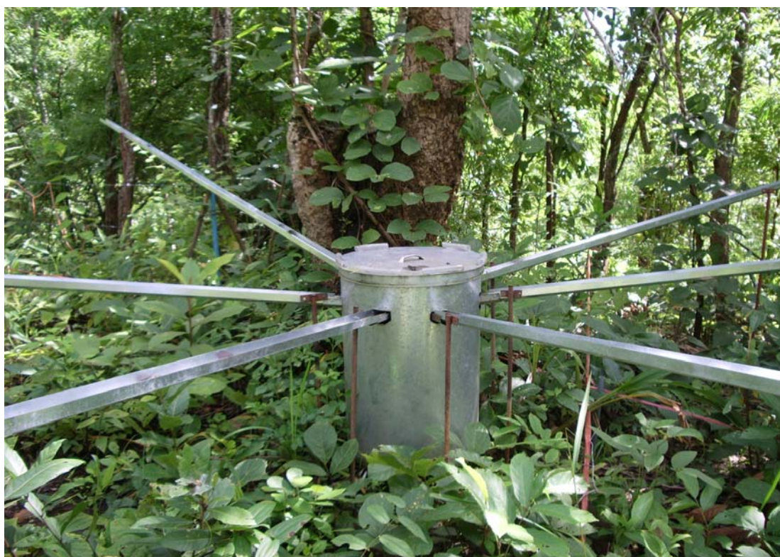
ภาพที่ 4 การติดตั้งเครื่องวัดน้ำฝนผ่านเรือนยอดแบบบนที่ก้อัดโนมัตชนิดด้วยกระดก
