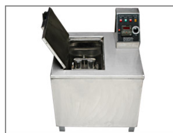
รูปที่ 3.5 เครื่อง Washing fastness tester (Penta Rapid-12)
