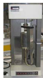
รูปที่ 3.3 เครื่อง Thermogravimetric Analyzer (TGA) (Perkin Elmer, TGA7HT)
