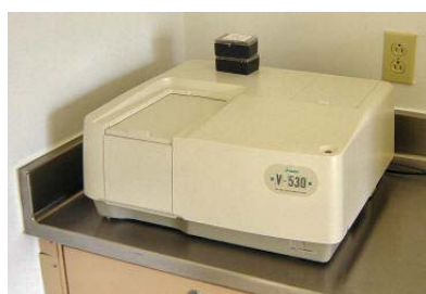
รูปที่ 3.4 เครื่อง UV/ Visible Spectrophotometer (Jasco, V530)
