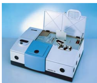
รูปที่ 3.1 เครื่อง Fourier Transform Infrared Spectrophotometer (FTIR) (Bruker Optic, Vertex70)
