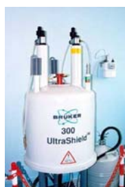
รูปที่ 3.2 เครื่อง Nuclear Magnetic Resonance Spectrometer (NMR) (Bruker, 300 UltraShield)
