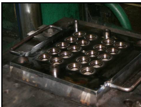
ภาพที่ 22 การเตรียม โมลด์สำหรับใช้ผลิตชิ้นงาน (ต้องทำการตรวจสอบสภาพผิวโมลด์ก่อน ทำการผลิต)
