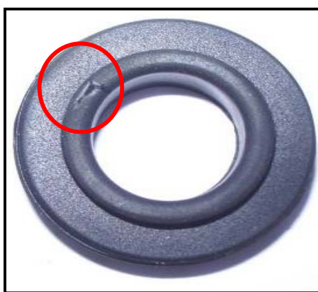
ภาพที่ 20 ลักษณะของชิ้นงานเนื้อยางไม่เต็ม
