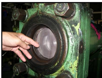
ภาพที่ 14 การประกอบตะแกรงเข้ากับหัวกระบอกร์ของ Extruder
