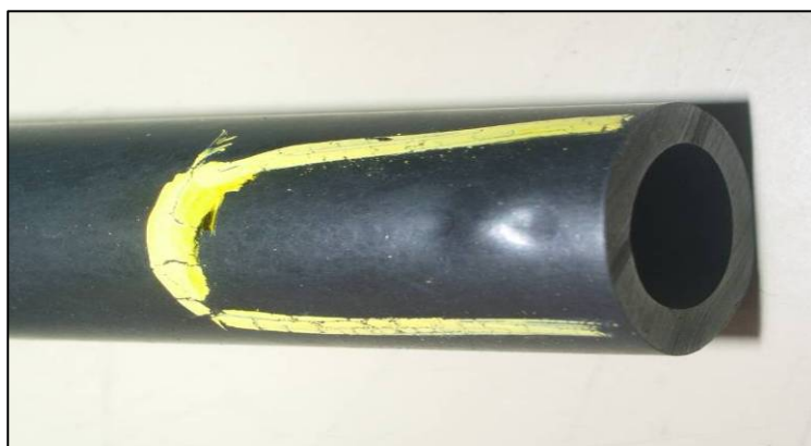
ภาพที่ 10 ลักษณะชิ้นงานที่มีปัญหาผิวชิ้นงานเป็นเม็ด
