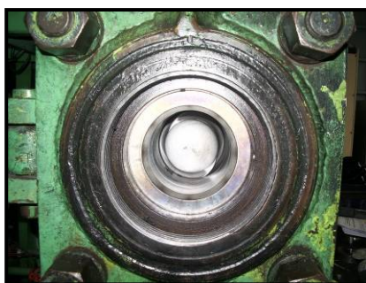
ภาพที่ 13 หัวกระบอกร์ของ Extruder
