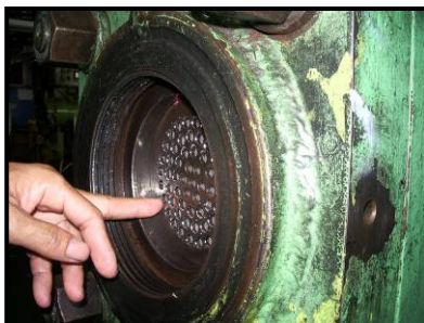
ภาพที่ 15 การประกอบแผงรังผึ้งทับตะแกรงเครื่อง Extruder
