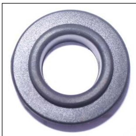
ภาพที่ 26 ลักษณะชิ้นงานที่มีสภาพผิวดีสมบูรณ์หลังจากผ่านการฉีดขึ้นรูป โดยเงื่อนไขที่เหมาะสม
