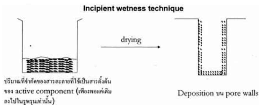
ภาพที่ 10 การเตรียมตัวเร่งปฏิกิริยาที่มีตัวรองรับด้วยวิธี Incipient wetness หรือการทำให้เอิบชุ่ม (Impregnation) [3]
