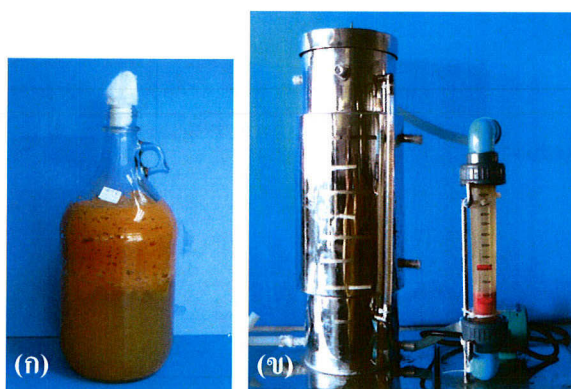
ภาพที่ 2 ลักษณะถังหมักที่ใช้ในการหมักไวน์จากกากแครอทด้วยเชื้อยีสต์ Saccharomyces cerevisiae M30 : (ก) ขวดแก้วที่ใช้ในการทดลองความเป็นไปได้; (ข) ถังหมักระบบหมุนวนเซลล์
