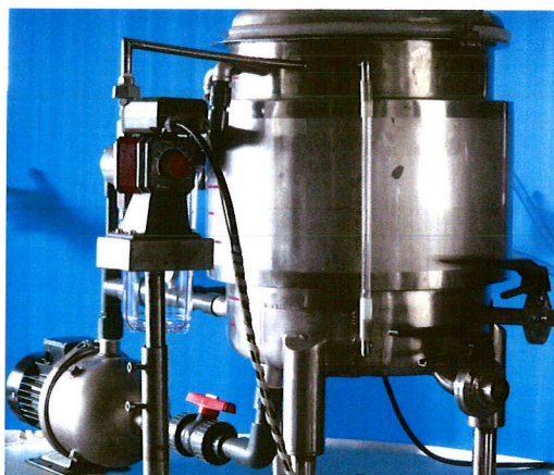
ภาพที่ 6 ลักษณะของถังหมัก “ระบบการหมักผสมน้ำหมักเข้ากับอากาศ” ขนาด 50 ลิตร ที่ใช้ในการผลิตน้ำส้มสายชูหมักจากไวน์กากแครอท
