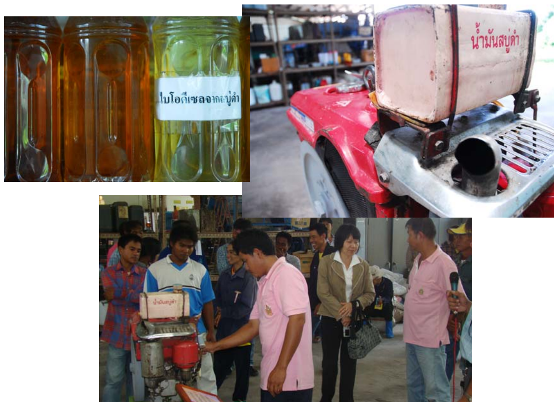
ภาพที่ 5 : การทดลองใช้น้ำมันไบโอดีเซลที่ผลิตได้จากสบูดำ
