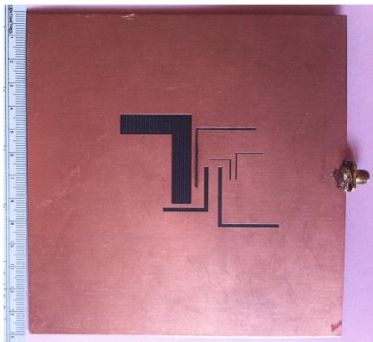
รูปที่ 3.8 สายอากาศช่องเปิด 6 ความถี่เรโซแนนซ์ที่สร้างบน RT/Duroid 5880
