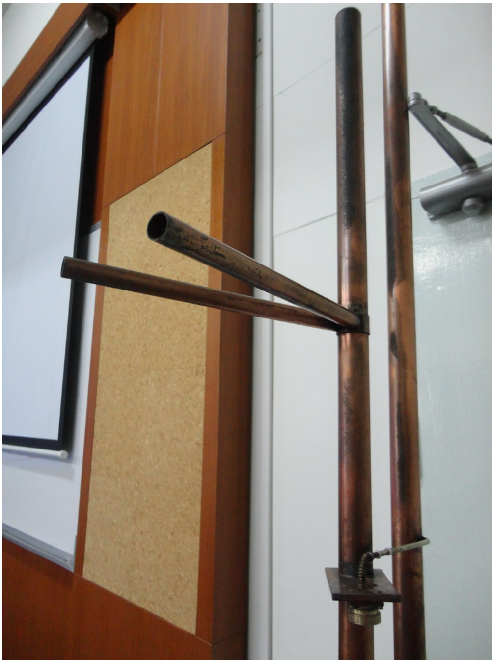
ภาพที่ 4.13 สตับที่ใช้ในการปรับค่าแมตซ์ของสายอากาศ
