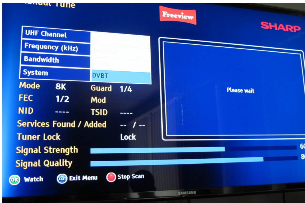
ภาพที่ 4.12 การทดสอบปรับค่าพารามิเตอร์ของระบบ DVB-T
