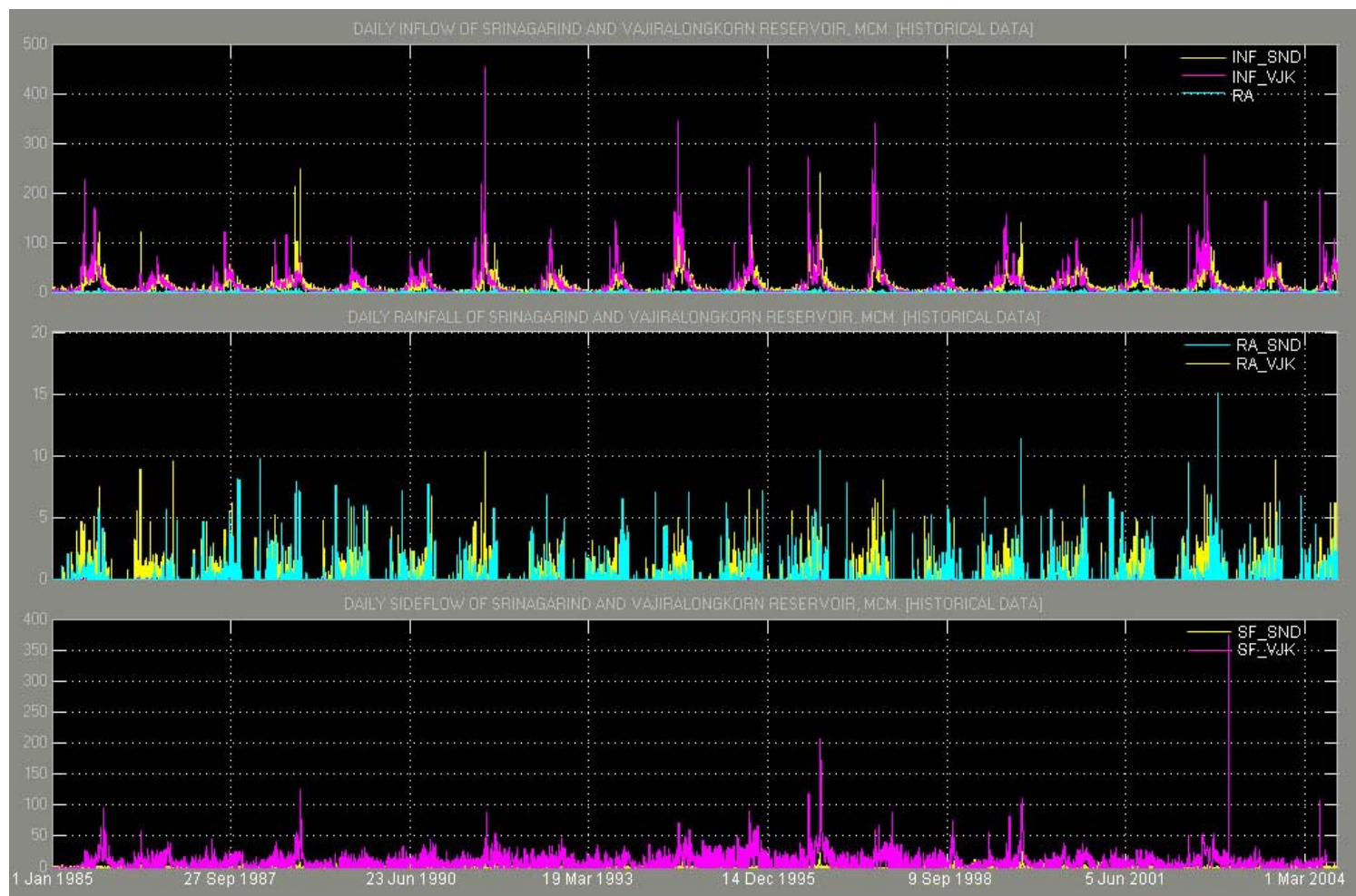
ภาพผนวกที่ ๑๑ ปริมาณน้ำต้นทุนของระบบลุ่มน้ำแม่กลองที่ใช้ในแบบจำลอง
