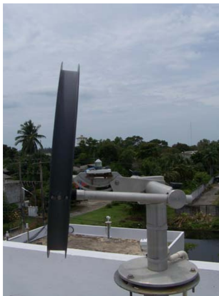
รูปที่ 3.17 แสดงอุปกรณ์วัด diffuse illuminance บนพื้นราบ ที่ศูนย์อุตุนิยมวิทยาภาคใต้ ฝั่งตะวันออก จังหวัดสงขลา
