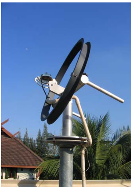
รูปที่ 3.8 แสดงอุปกรณ์วัด diffuse illuminance บนพื้นราบ ที่ศูนย์อุตุนิยมวิทยาภาคเหนือ จังหวัดเชียงใหม่
