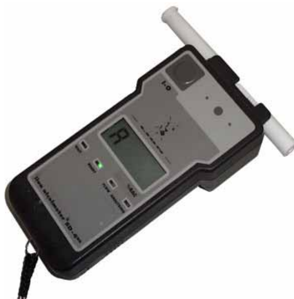
ภาพที่ 22 เครื่องวัดระดับแอลกอฮอล์ในเลือด Lion Alcolmeter SD หมายเลข 056055 D
