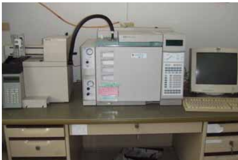
ภาพที่ 23 เครื่องแก๊สโครมาโตกราฟ (GC) ชนิด capillary column ยี่ห้อ Hewlett Packard รุ่น HP 6890 Series
