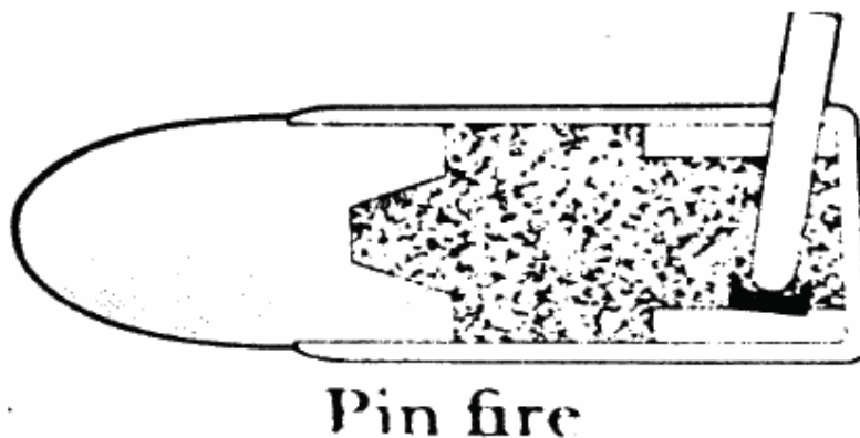
ภาพที่ 2 โครงสร้างกระสุนปืนแบบ Pin Fire
