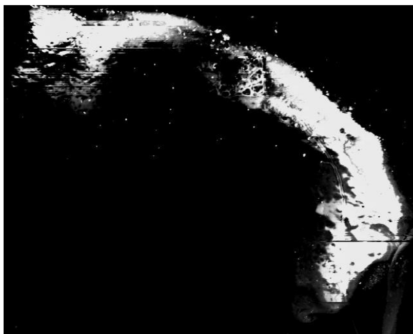
ภาพที่ 22 การกระจายตัวของเขม่าป็น (บริเวณที่เรืองแสง) ของปืน Semi-automatic ขนาด 9 มม. ที่กำลังขยาย 180X ตำแหน่งหมายเลข 1 ในทิศของการยิง ห่างจากจุดยิง 1 เมตร ซึ่งมีจำนวนอนุภาคของเขม่าป็นมากที่สุด
