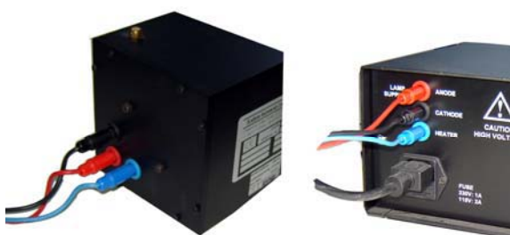
รูป A1.3 แสดงการต่อสายไฟจากแหล่งจ่ายเข้ากับหลอดมาตรฐาน
