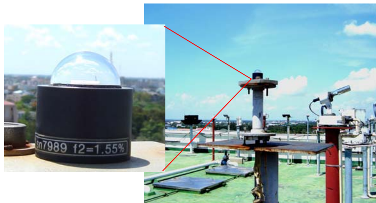
รูปที่ 3.1 แสดงหัวรับรังสีของ spectroradiometer ที่ติดตั้งอยู่บนดาดฟ้า อาคารวิทยาศาสตร์ 1 มหาวิทยาลัยศิลปากร จังหวัดนครปฐม
