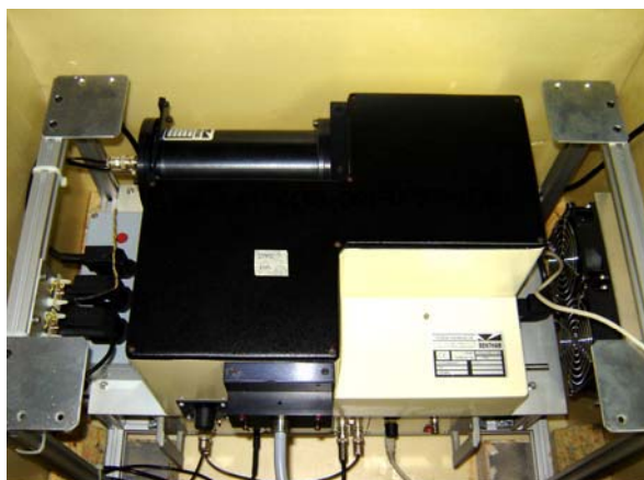
รูปที่ 3.2 แสดงเครื่อง spectroradiometer ซึ่งตั้งอยู่ที่ห้องเครื่องมือได้คาดฟ้าชั้น 10 อาคาร วิทยาศาสตร์ 1
