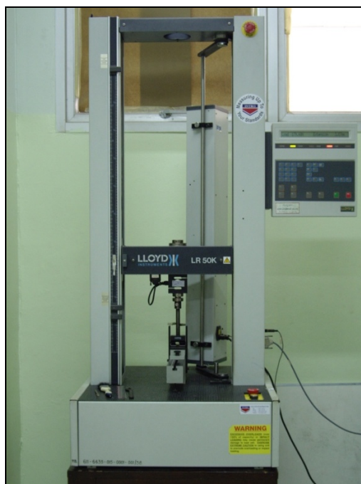
รูปที่ 3.9 เครื่อง Universal Testing Machine เพื่อทดสอบความสามารถในการดึงยึดของวัสดุ
