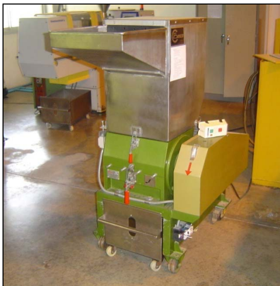
รูปที่ 3.5 เครื่องย่อยเม็ดพลาสติก (Plastic grider)
