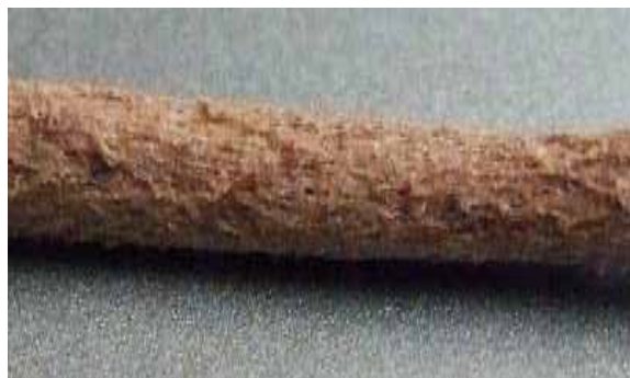
ภาพที่ 41 แสดงการเกิดรอยฟืนฉลามที่ของวัสดุคอมโพสิตของผงไม้กับเอบีเอสในการทดสอบสมบัติการไหลที่อัตราความเร็วเฉือนสูง
