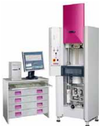
ภาพที่ 29 แสดงเครื่องทดสอบการไหลแบบ Capillary die rheometer ยี่ห้อ CEAST รุ่น Rheologic 5000 [41]
