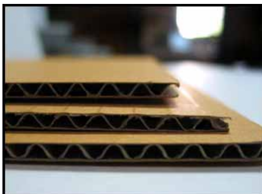
ภาพที่ 22 แสดงแผ่นกระดาษลูกฟูกชนิด Single Wall
