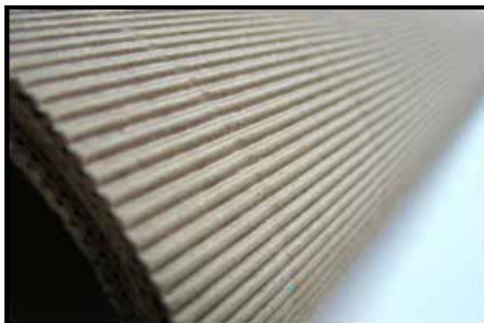
ภาพที่ 21 แสดงแผ่นกระดาษลูกฟูกชนิด Single Face
