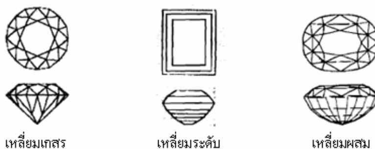
ภาพที่ 10 แสดงรูปทรง (Style) ของการเจียรระโนแบบหน้าเหลี่ยมในลักษณะต่าง ๆ
