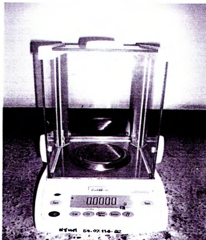
ภาพ ฉ เครื่องชั่งละเอียด 4 ตำแหน่ง ยี่ห้อ Artorius รุ่น BP 210 S
