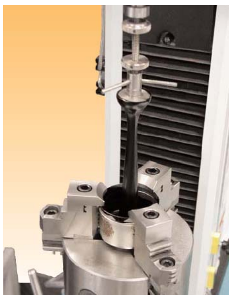
รูปที่ 22 แสดงตัวอย่างการทดสอบความเหนียวและเทนซิตี [23]
