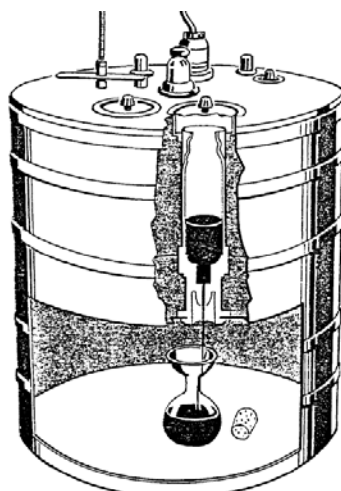
รูปที่ 18 การทดสอบหาความหนืดแบบเซย์โบลต์ฟูร์ลด [22]
