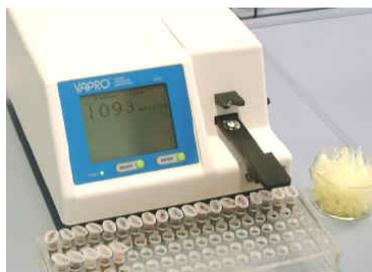
ภาพผนวกที่ 7 วัสดุ อุปกรณ์ และเครื่องมือในการหาค่าพลังงานศักย์น้ำภายในใบกระเจี๊ยบเขียว ในรอบวัน
