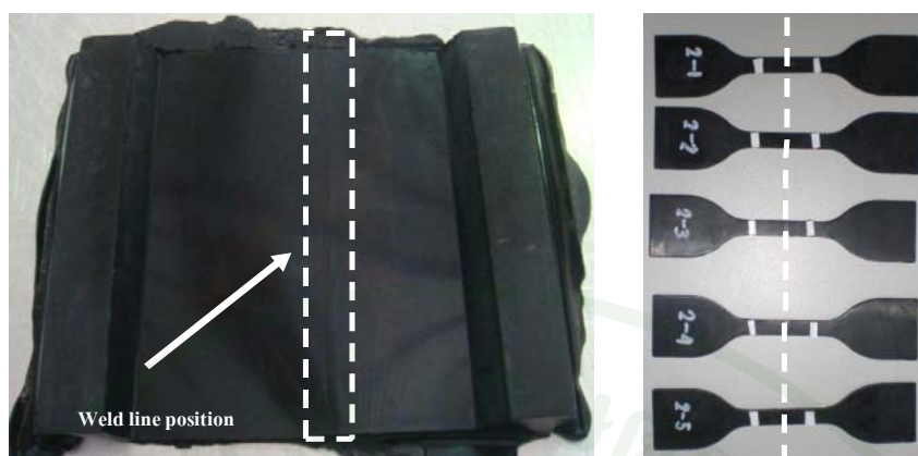
ภาพที่ 27 ชิ้นงานยางที่มีรอยประสานและชิ้นงานทดสอบความต้านทานต่อแรงดึง
