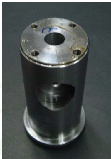
ภาพที่ 18 ชุดปรับเปลี่ยนทิศทางการไหลของพอลิเมอร์ชั้นแกนกลาง
