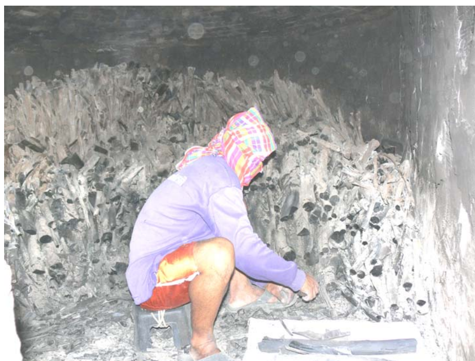
ภาพที่ 8 ลักษณะของถ่านที่ผลิตภายในเตาผลิตถ่านไทย-อิวาตะ
