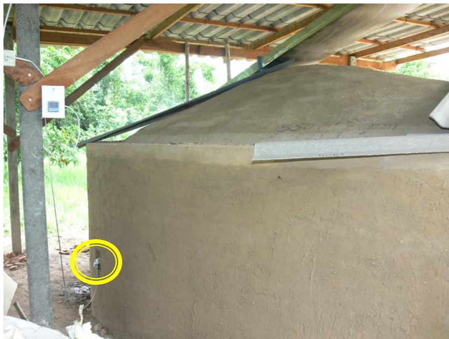
ภาพที่ 5 ตำแหน่งที่ใช้วัดอุณหภูมิภายในเตาผลิตถ่านไทย-อิวาเตะ
