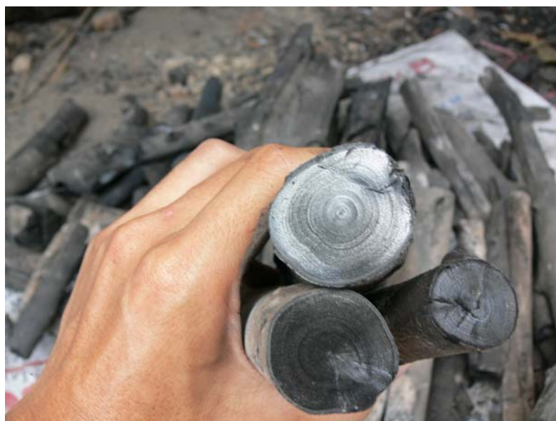
ภาพที่ 9 ลักษณะของถ่านไม้ยูคาลิปตัสที่ได้จากการผลิตโดยเตาผลิตถ่านไทย-อิวาเตะ
