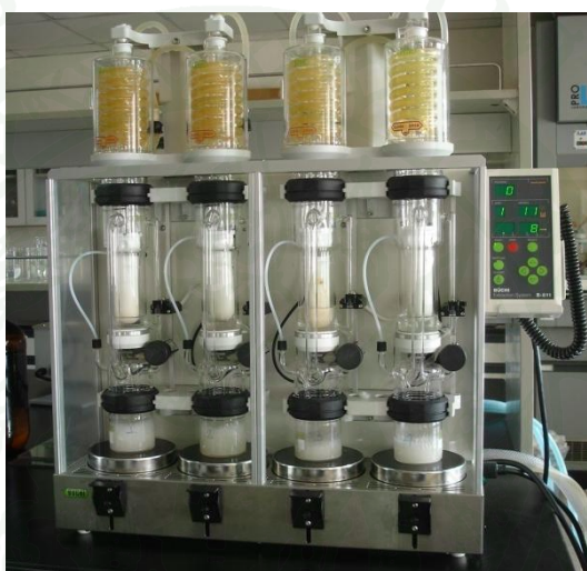
ภาพที่ 10 เครื่อง soxhlet extractor (Buchi Universal Extraction System B-811) ที่ใช้ในการสกัดน้ำมันของปาล์มน้ำมันแบบดুরา สายพันธุ์บางเบ็ดทั้ง 33 ต้น
